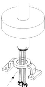
Поднимите декоративную крышку и прикрепите трубу с помощью фиксатора.
