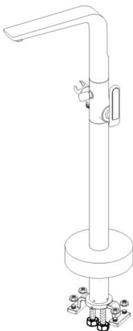
Подключите красный шланг к горячей воде, синий к холодной. Затем закрепите расширительные винты к полу.
