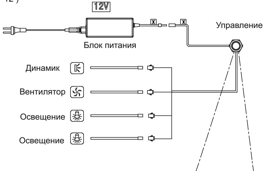
При первом нажатии на кнопку включения, включается освещение (белый цвет), вентилятор и Bluetooth.
