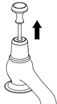
Данный смеситель оборудован донным клапаном, который срабатывает при поднятии вверх ручки на кране.
