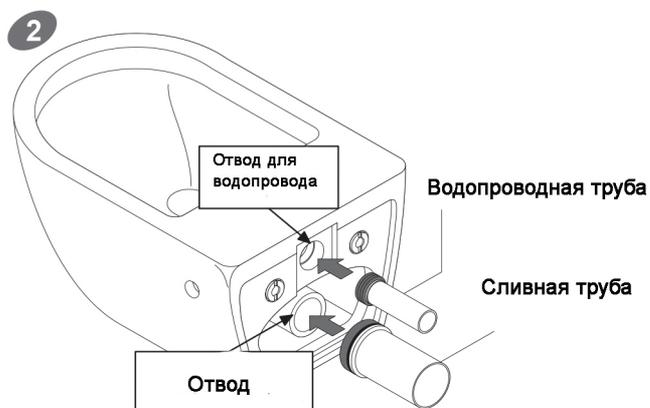
Подсоедините водопроводную трубу с уплотнительным кольцом к отливу для водопровода.
