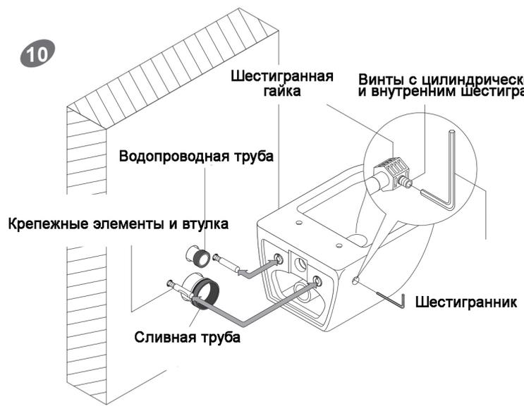
Подсоедините унитаз к стене с помощью крепежных элементов. Для этого воспользуйтесь шестигранником. Убедитесь, что сливная и водопроводная труба плотно подсоединены к отливу.
