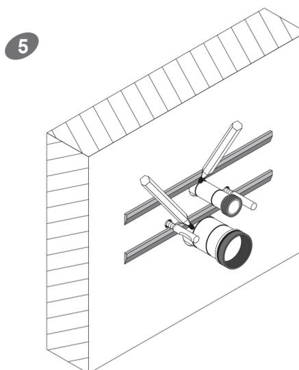
Вставьте сливную и водопроводную трубу во внутренние отверстия с отводом в стене и начертите разметку карандашом как показано на рисунке.
