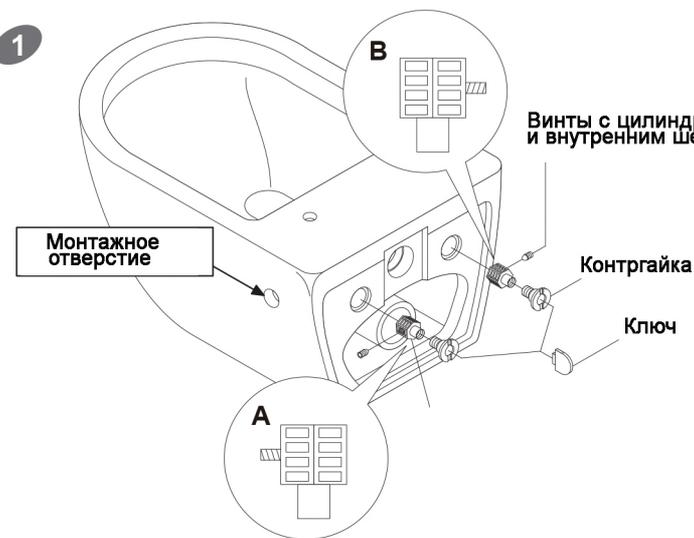
Подсоедините винты с цилиндрической головкой и внутренним шестигранником на шестигранные гайки.
