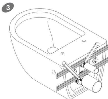
Начертите карандашом разметку вокруг сливной и водопроводной трубы как показано на рисунке.
