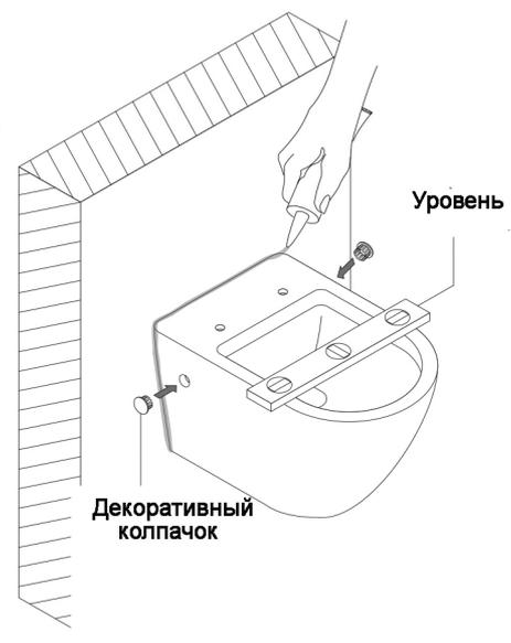
Удостоверьтесь, что унитаз плотно закреплен и не шатается. После выравнивания нанесите силиконовый герметик на месте стыка по всей длине.
