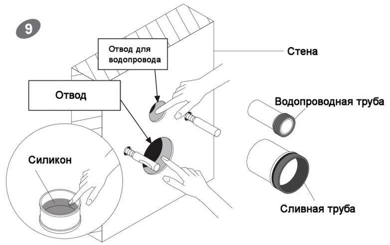
Смажьте внутренние отверстия с отводом в стене силиконом и вставьте в него сливную трубу
