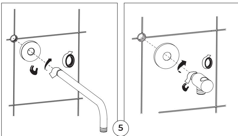
5. Установите излив верхнего душа и штуцер с держателем ручного душа, уплотните резьбы лентой фум.
