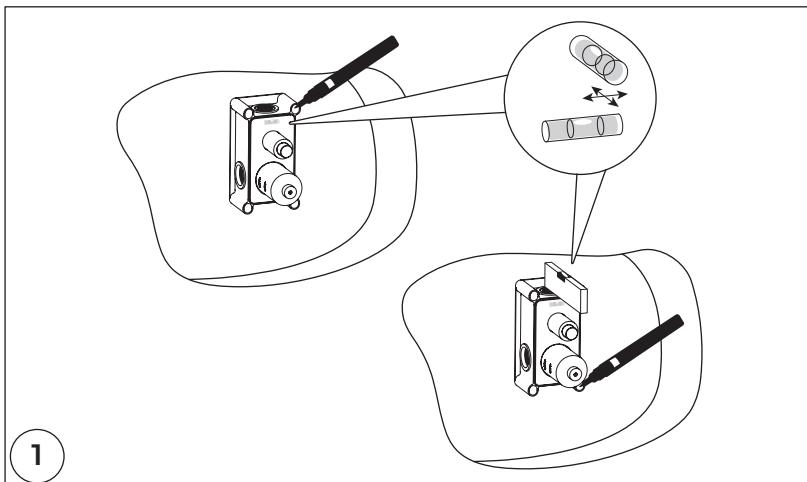
1. Отметьте точное расположение мест крепления. Просверлите отверстия и установите в них дюбели.
