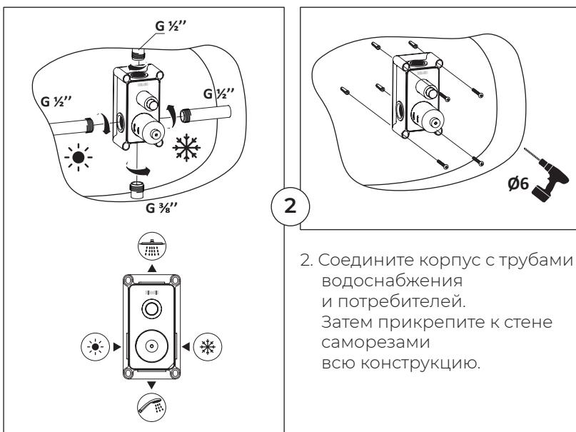
2. Соедините корпус с трубами водоснабжения и потребителей. Затем прикрепите к стене саморезами всю конструкцию.
