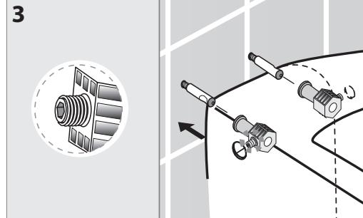
**4**\_Serrare il grano con la chiave fornita nel kit avendo l'accortezza di tenere il sanitario ben accostato alla parete. Si consiglia di avvitare i fissaggi un po' alla volta alternando l'azione su entrambi fino al completo bloccaggio del pezzo.
