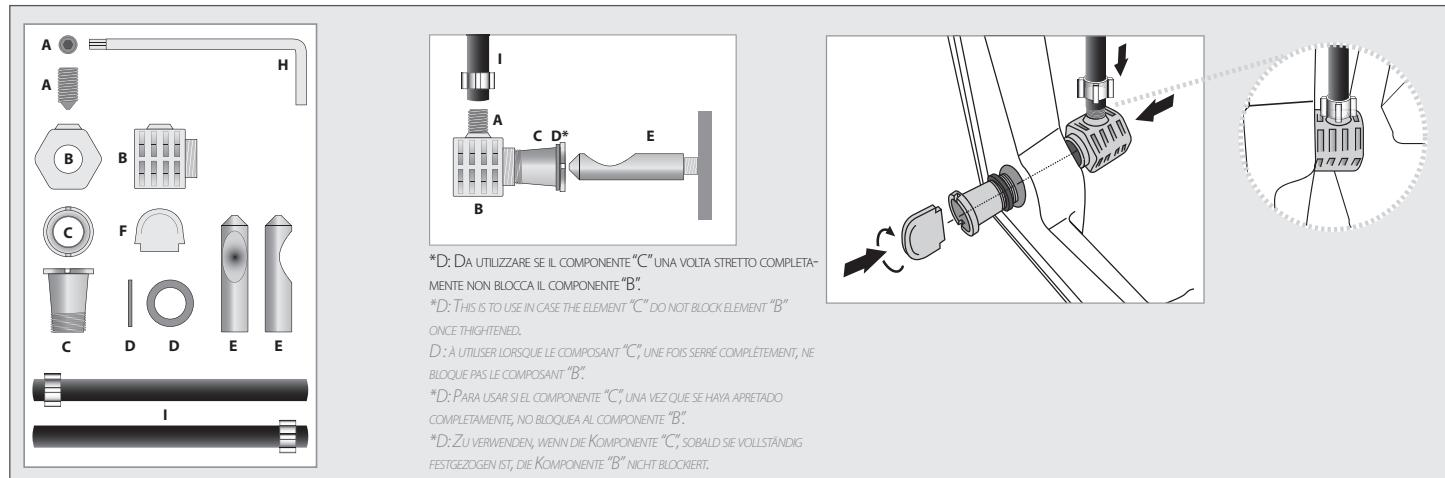
**1** Prédisposer les évacuations et les pivots des étriers selon les dimensions indiquées sur les fiches techniques. Découper les pivots filetés selon la dimension indiquée dans l'illustration. Visser les deux cylindres en acier jusqu'à la dimension indiquée dans la figure. ATTENTION : les deux ouvertures doivent être tournées vers le côté d'actionnement du goujon.
