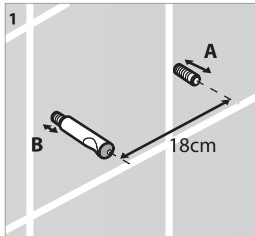
**2**\_Predisporre il raccordo per lo scarico della cassetta secondo la misura riportata nel particolare ingrandito. Montare il raccordo di scarico sul sanitario e tagliarlo secondo la misura riportata nell'illustrazione. A questo punto posizionare il pezzo sui perni in acciaio e spingerlo fino a parete facendo attenzione che tutti i raccordi si innestino perfettamente (attenzione per agevolare l'innesto si consiglia di lubrificare entrambe le parti).
