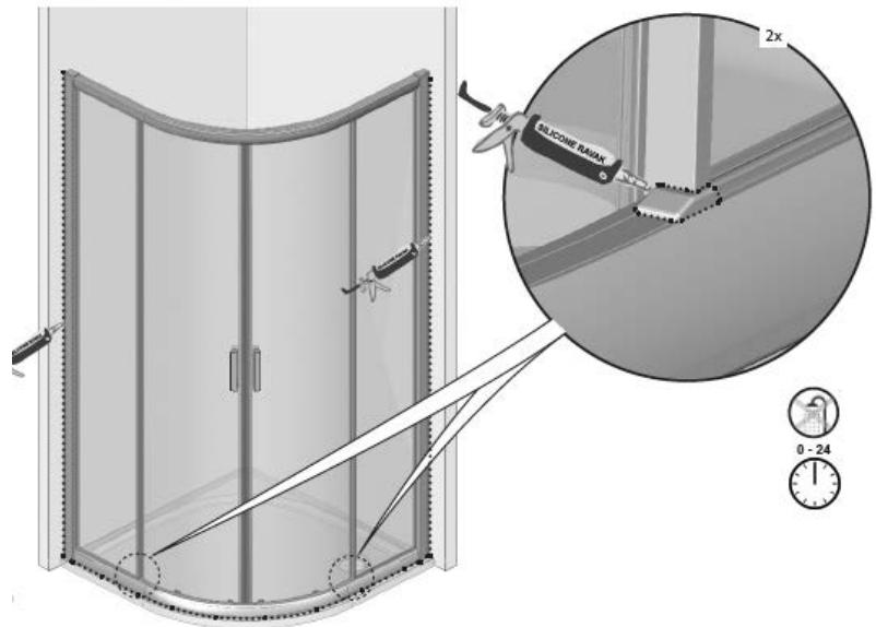
Необходимо провести герметизацию стыковых соединений, силиконовым герметиком RAVAK
