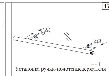
Закрепите одно крепление штанги на стену, затем вставьте в него штангу и закрепите ее с помощью небольшого винта (a-b).
