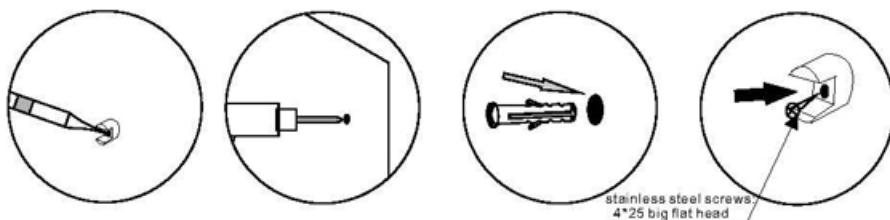
10. Разметьте расположение полок на стене, просверлите отверстия и установите полки.
