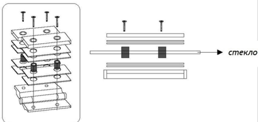
4. Установите петли на дверь, используя по 2 силиконовые прокладки с каждой стороны и проставочные втулки по центру.
