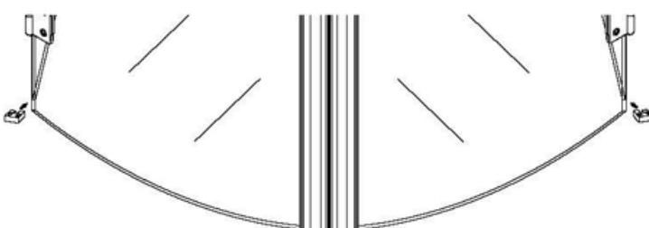
8. Разметьте и установите фиксаторы неподвижных стекол.
