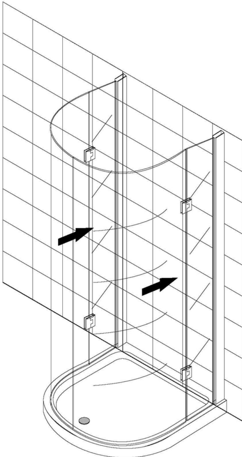
5. Вставьте ответные профиля в П-образный профиль, закрепите их. Вставьте неподвижные стекла и зафиксируйте их резиновыми уплотнителями.
