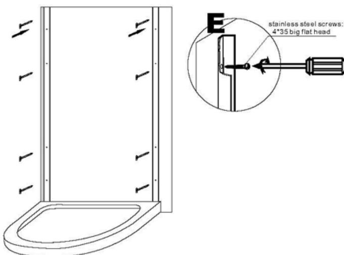
3. Просверлите отверстия в стене и закрепите П-образные профили.
